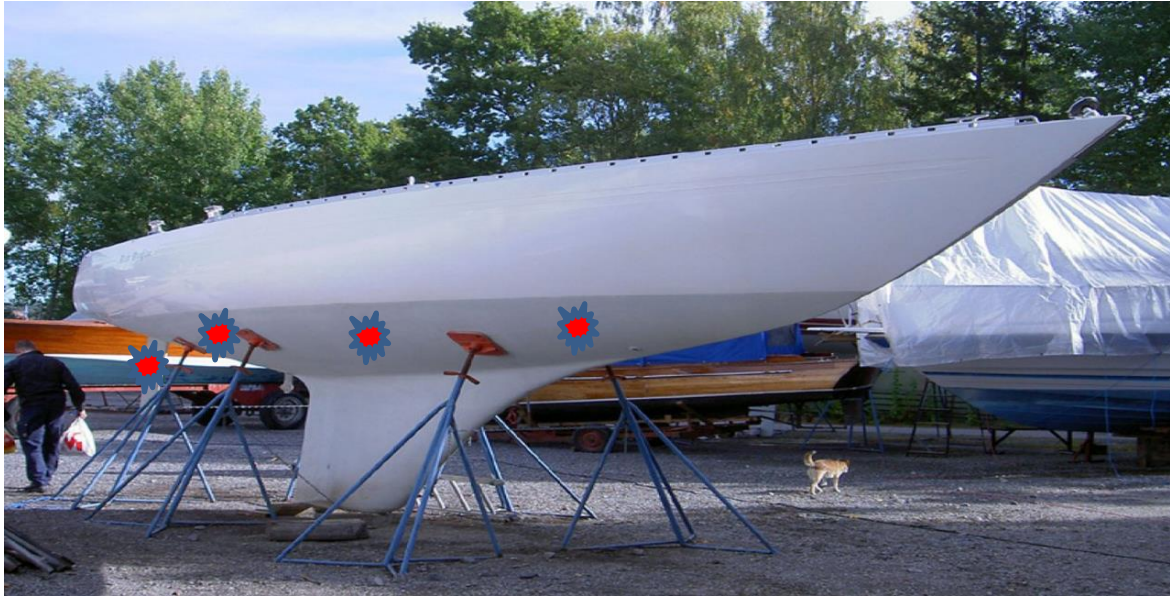
Figur 1. Mätpunkter på båtar mätta av Happy Boat AB. Mätningar utfördes 10-20 cm nedanför vattenlinjen på både styrbord och babord sida enligt bilden (styrbord bak, styrbord mitt, styrbord för, babord för, babord mitt och babord bak plus ömse sidor av rodet). Om det var motorbåtar mättes på aktern istället för roder.
